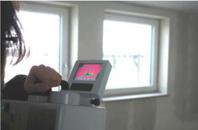
Thermografie – Methodik zur Aufdeckung von Wärme- bzw. Kältebrücken
