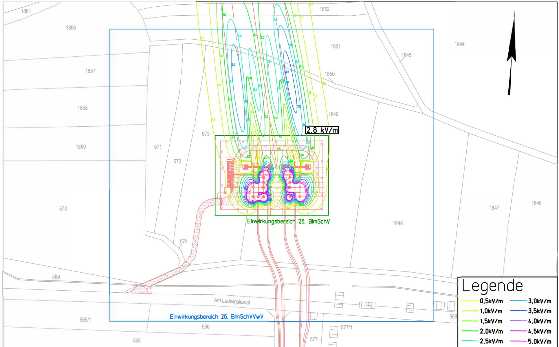
Darstellung der Einwirkungsbereiche nach 26. BImSchV und 26. BImSchVVwV sowie der magnetischen Flussdichte Kabelübergangsanlage KA\_MUHN
