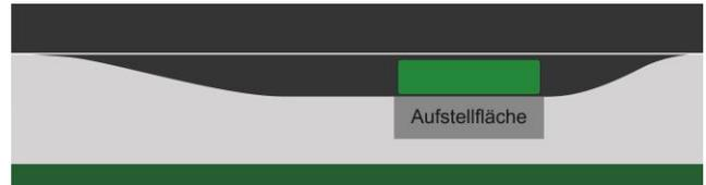
Abb. 3: Die Busbucht befindet sich wie eine zusätzliche Fahrspur rechts neben der Fahrbahn und galt in der Vergangenheit (zu Zeiten noch geringeren Straßenverkehrs) häufig als Regelfall einer Haltestelle.
